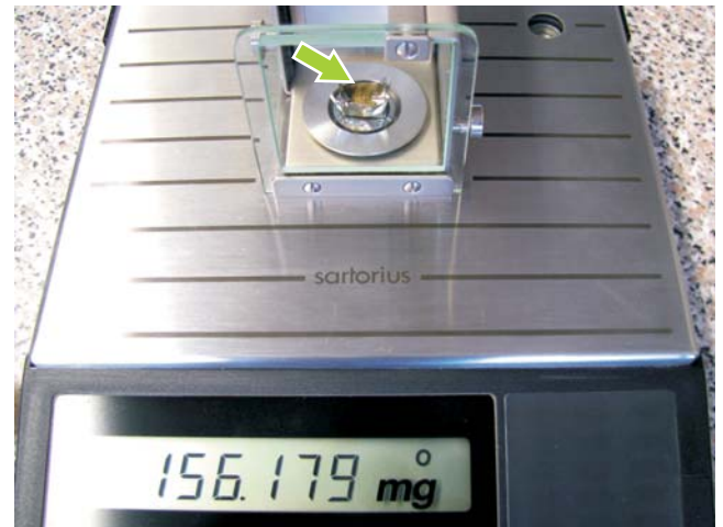
Für die Bestimmung von Stickstoff und Humus wird der Boden in kleine Zinnbehälter verpackt und bei 1140° C verbrannt. In den Verbrennungsgasen wird Stickstoff, Kohlenstoff und Schwefel bestimmt.
