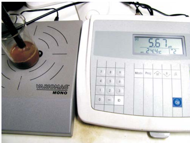
Messung des pH-Wertes einer Bodenprobe
