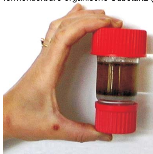
Die Substratprobe wird in speziellen Glastiegeln mithilfe von verschiedenen Enzymen verdaut.
